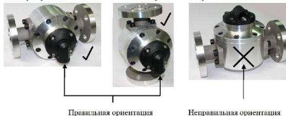
Примечание: кабельный вывод должен быть повернут вниз для того, чтобы избежать попадания влаги в камеру с электронными компонентами через зазор между кабелем и уплотнителем ввода кабельного наконечника.
